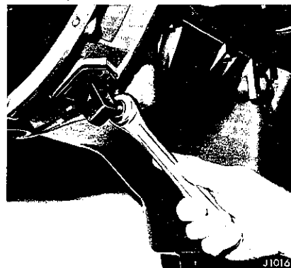
Drehvorrichtung am Schauloch-Steuergehäuse angeschraubt
