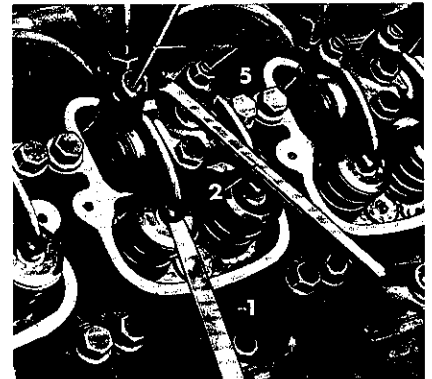
Ventilspiel einstellen 1 Fühlerlehre 4 Einstellschraube 2 Ringschlüssel 5 Gegenmutter 3 Schraubenzieher
