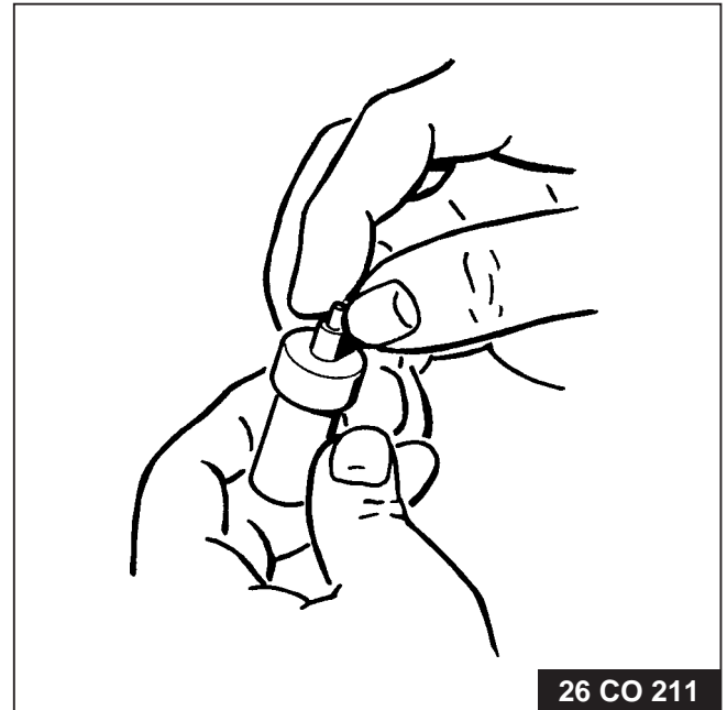
Fig. 5. De glijproef. Het controleren van de passing van de verstuivernaald in het verstuivermondstuk.
