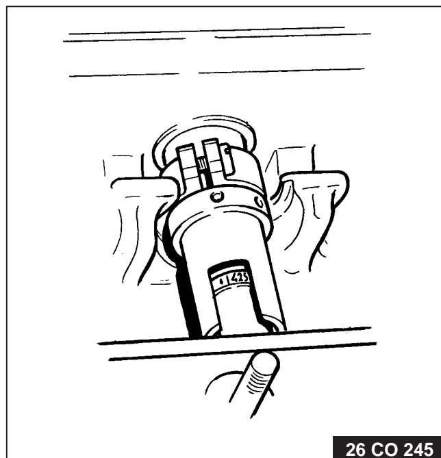
Fig. 12. De plunjernok moet zodanig in de sleufbuis steunen, dat cijfers en pijltje op de plunjernok van de regelstang af staan gekeerd.
