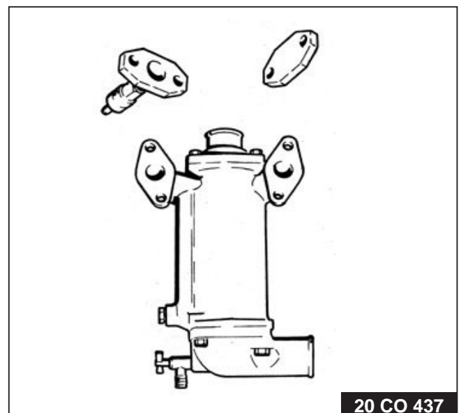
Fig. 49. Het afpersen van de complete oliekoeler vindt plaats met behulp van het DAF-gereedschap 2-99-535608 en perslucht; afpersdruk 5 ato.
