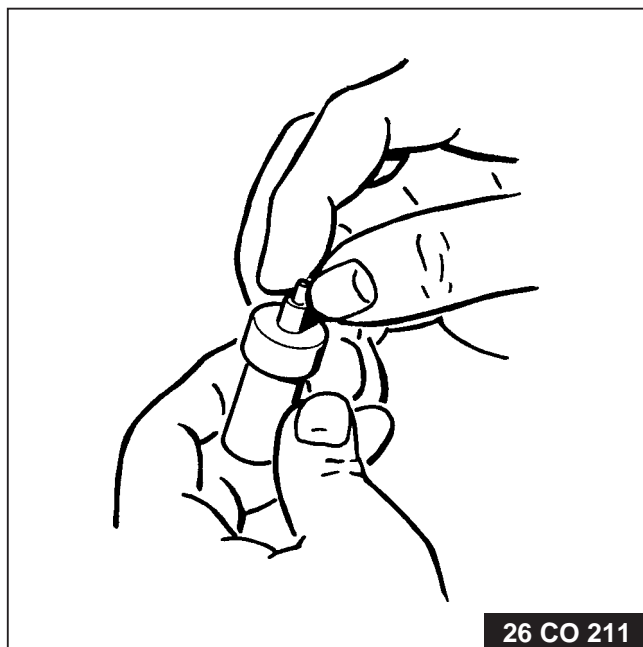
Fig. 5. De glijproef. Het controleren van de passing van de verstuijvernaald in het verstuijvermondstuk.
