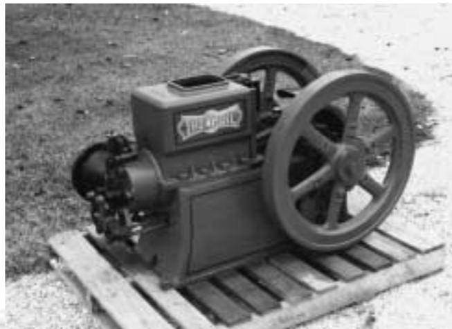
Een 3 pk viertakt Thermoil motor. A 3 hp fourstroke Thermoil engine, built by Hercules and sold as a Sears, Roebuck & Co engine. Ein 3 Ps. Viertakt Sears, Roebuck & Co Thermoil Motor mit Zündkapsel.
