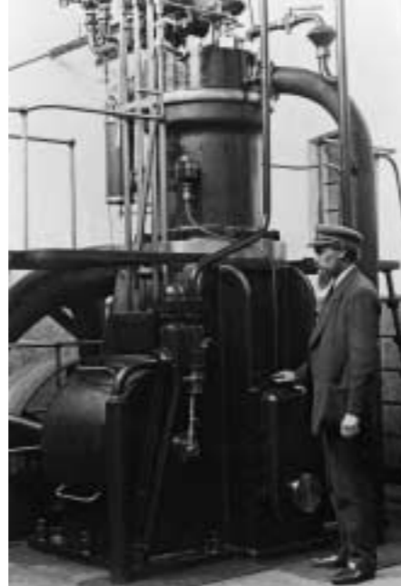
Jan Brons, staande naast zijn schepping, een 1 cilinder Bronsmotor van 60 pk. Deze motor diende voor het drijfwerk in de machinale afdeling van de Bronsmotorenfabriek. Mr. Jan Brons, standing beside his one cylinder Brons engine of about 60 hp. This engine drove the machinery shop of the Bronsfactory in Appingedam. Der Herr Jan Brons bei seinem 1-Zylinder 60 Ps. Bronsmotor. Dieser Motor wurde genutzt für den Antrieb der Maschinerie in der Fabrik.
