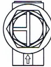
Filter links ingeschakeld Filter rechts gereed voor het schoonmaken
