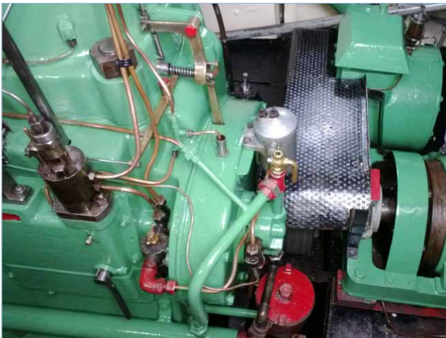
De Bronsmotor met blower en Brevo keerkoppeling (in 2017).
