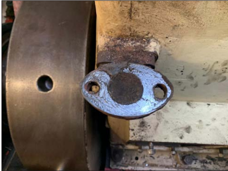
Volledig geblokkeerde koelwaterbocht
