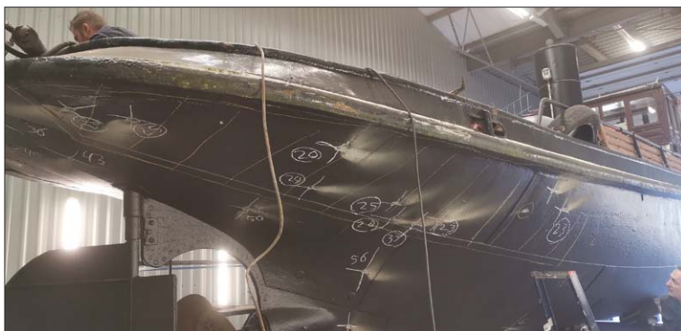
Onderwaterschip na de vlakkeuring en het is een heus kruizen-festijn (foto: E.Mötter 2022)
