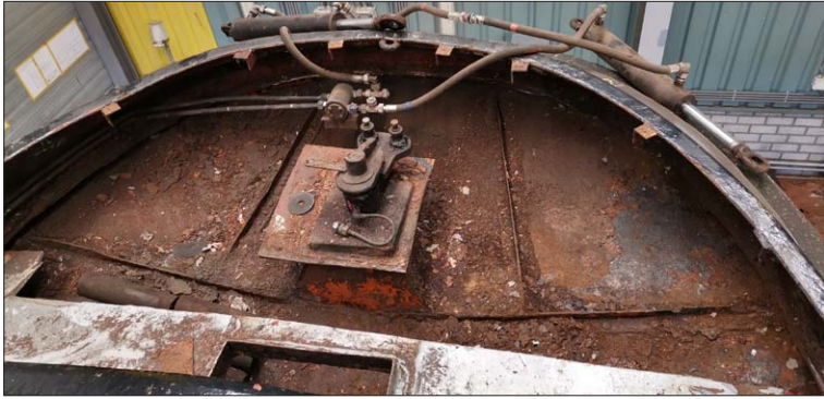
Stuurcilinders, achterdek en purschuim verwijderd ...da's niet best (foto: E.Mötter 2022)
